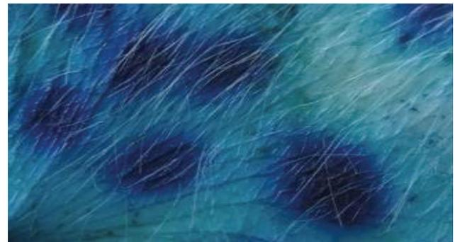
**Bild 8** Infusionsversuche an einer Schweinehautprobe. Eine Menge von 100 µl einer blau gefärbten Lösung konnte mit einem Druck von < 0,5 bar und einem Volumenstrom von 100 µl/h in die Haut abgegeben werden.
