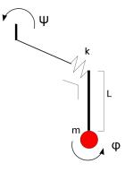
Abbildung 1: Sketch of pendulum.
